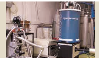
設備・機器名: 円二色性分散計 メーカー (型式): 日本分光 J720 オックスフォード SM4000 所属: 理学研究所 仕様・特徴: 測定波長170 ~ 1000nm 磁場: 0 ~ 7T 温度: 4.2 ~ 300K
