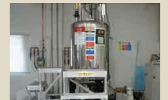
設備・機器名: 核磁気共鳴装置 (500MHz NMR) 液体用 メーカー (型式): Agilent (varian) Unity INOVA500LC 所属: 基礎工学研究所 仕様・特徴: 500MHzフーリエ変換核磁気共鳴装置、温度可変装置 (-10°C ~ 130°C)
