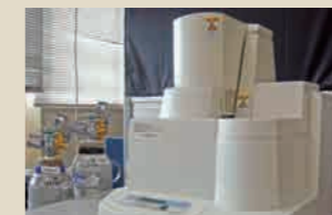
設備・機器名: 示差熱-熱量分析装置 メーカー (型式): 島津 DTG-60 所属: 科学教育機器リノベーションセンター (吹田) 仕様・特徴: 室温 ~ 1100°C までの示差熱分析 (DTA) と熱量測定が同時に可能
