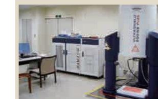
設備・機器名: 超高磁場小動物MRI装置 メーカー (型式): Bruker AVANCE II 500WB 所属: 免疫学フロンティア 仕様・特徴: 超伝導マグネット11.7T、小動物用磁気共鳴イメージング装置 (MRI)
