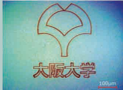
真空紫外レーザー (193nm)による加工例
