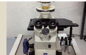
設備・機器名: 蛍光顕微鏡 メーカー (型式): カールツァイス LSM510 所属: 免疫学フロンティア研究センター 仕様・特徴: 細胞内部の高解像度3次元計測
