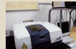
設備・機器名: 赤外分光光度計 メーカー (型式): 日本分光 FT/IR 6100 所属: 理学研究所 仕様・特徴: 測定波数範囲7800-350 cm -1 極低温 (約5K) までの測定可能
