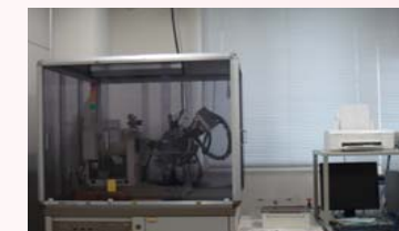
微小X線応力測定装置 (No.69) リガク・MSF-2M-PSPC 設置部局: 科学教育機器リノベーションセンター 特徴: 金属、セラミクスなどの残留応力を非破壊で測定可能
