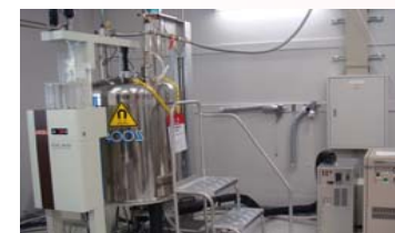
核磁気共鳴装置 (No.70) 日本電子・ECS400 設置部局: 工学研究科 仕様: 1 H 400 MHz, 13 C 100 MHz 5mm FG/THチューナブルプローブ
