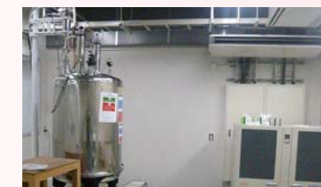
核磁気共鳴装置 (No.67) 日本電子・ECA500 設置部局: 理学研究科 仕様: 1 H 500 MHz, 13 C 125 MHz 5mm TH5ATFG2プローブ
