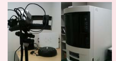
3次元スキャナ装置 ABS樹脂積層型3次元造形装置 (No.65) Solutionix・RexcarIII/Stratasys・Dimension BST 3D 設置部局: 工学研究科 特徴: スキャンした3次元CADデータから、立体造形物を作成可能
