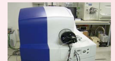
LC-MS/MSシステム (No.68) Waters・Q-ToF Ultima API 設置部局: 工学研究科 特徴: 有機化合物、ペプチド、生体分子などの構造解析に必要な高分解能質量分析が可能。
