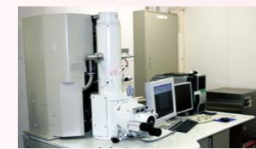
EDS元素分析システム搭載電界放射走査電子顕微鏡 (No.64) 日本電子・JSM-6335、JED-2300F 設置部局: 産業科学研究所 仕様: 倍率 ×10~500,000 二次電子分解能 1.5 nm 測定可能元素 B(5)~U(92)
