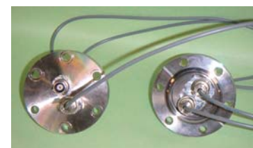
フランジにフィードスルーを取り付けた様子
