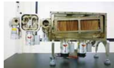
図1 高性能小型マルチターン飛行時間型質量分析計
