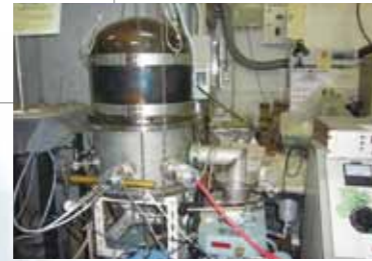
写真1 高融点材料用電子ビーム蒸着装置
