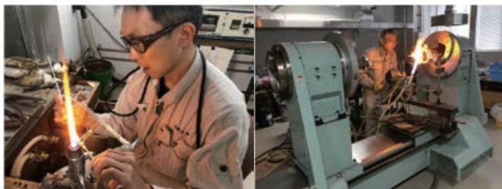
図3 ガスバーナー(左)やガラス旋盤(右)を使って、カスタムメイドのガラス実験器具を製作する坂口技術専門職員(左)と山口技術専門員(右)。啜えているゴムチューブは、ガラス器具内部に息を送り込んで加圧するためのもの。ガスバーナーで炙った部分は軟化し、内部加圧によって膨らむ。これを成形や吹き破り(穴開け)といったガラス加工に利用している。
