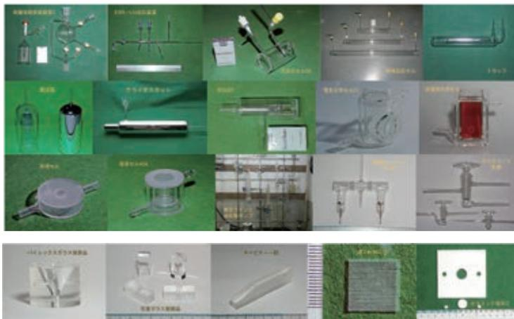
図2 研究者からのリクエストに応じて、ガラス工作メインショップで製作したガラス実験器具の例。(上) ガスバーナーによる熱的加工で製作したガラス実験器具の例。(下) 超音波加工機などを用いた機械的加工による製作例。
