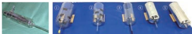
図5 (左) ガラス工作メインショップで製作した、極低温物性実験に用いる液体ヘリウム用ガラスクライオスタット。液体ヘリウムをためるデュワー(中央部とガラス細管部)と、それを保冷する液体窒素用のデュワーとが、入れ子構造に配置されている。(右) デュワーの基本構造である二重壁構造を、ガラス工作で作る手順。①2つのガラス管を同軸状に配置、②開放端をガラス封止、③内部の銅メッシュを酸で溶解除去、④銀めっき、⑤二重壁内部を真空引きしたのち、封じ切って完成。
