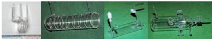
図4 ガラス工作によって製作された、様々なガラス分析セルやガラス反応チャンバーなど。見た目は非常に複雑だが、ガラス工作では短時間で製作することができる。
