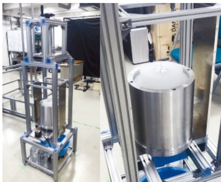
図3 開発した「低粘度測定に特化した共軸二重円筒型回転粘度計」の2号機。白色の円柱部と外側の円筒部の間(空隙は数mm程度)に試料流体を満ち、外側の円筒部を回転させ、円柱部にかかるトルクをワイヤーねじり天秤で測定する。
