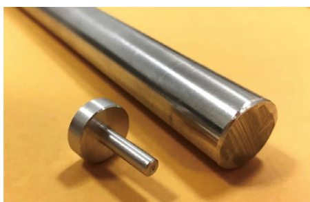
図2 機械工作実習で製作するガラス管電極とその材料であるアルミ棒。
